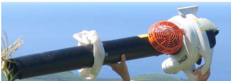
Figure 4 : Aspirateur à moteur (dérivé du D-Vac), (Rapport S. DUHAUTOIS)
